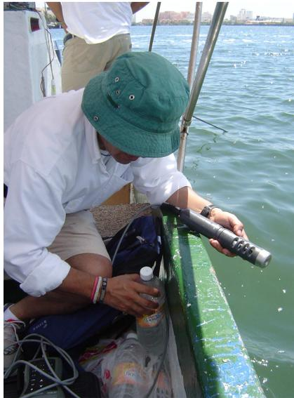
**Foto 24. Medición de parámetros fisicoquímicos con un medidor multiparamétrico portátil Marca Hanna.**
